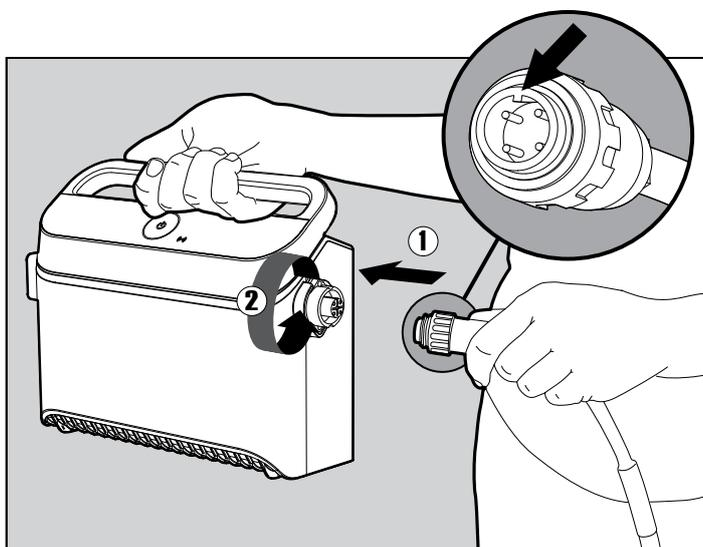
**5.1.3** Raccordez le câble flottant au boîtier d'alimentation électrique : insérez le câble avec le cran sur le connecteur (1), aligné sur la rainure dans la prise du boîtier d'alimentation électrique, et tournez dans le sens des aiguilles d'une montre (2).
