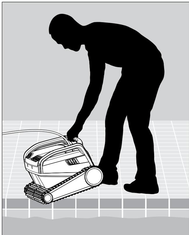
**5.2.1** Placez le robot nettoyeur dans la piscine. Lâchez-le et laissez-le couler jusqu'au fond de la piscine. Veillez à ce que le câble flottant ne soit pas confronté à des obstacles.
