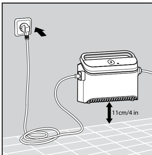
**5.3.1** Connectez le boîtier d'alimentation électrique au courant alternatif.
