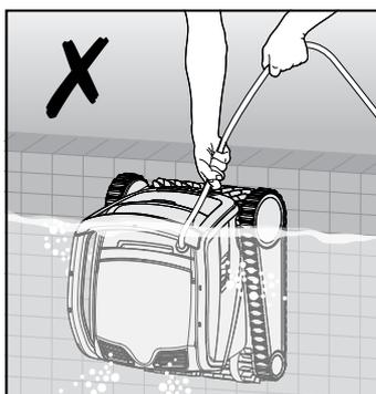
5.7.2 Utilisez le câble flottant pour tirer le robot nettoyeur de piscine vers le côté de la piscine. Utilisez la poignée pour retirer le robot de la piscine.
