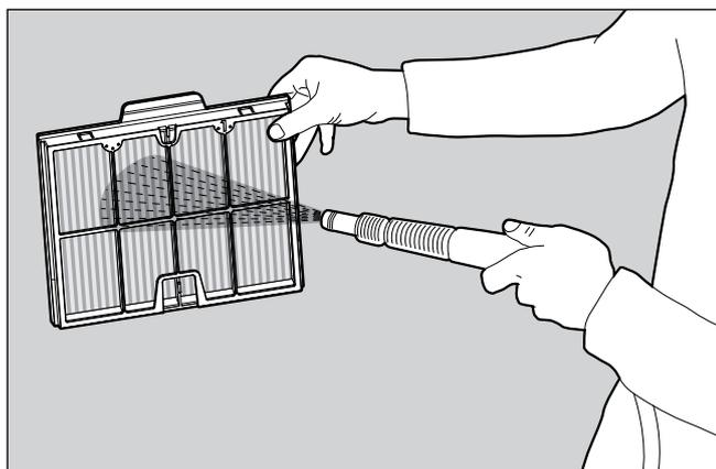
**6.2.4** Nettoyez les panneaux filtrants avec un tuyau d'arrosage.
