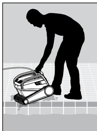
5.7.3 Déposez le robot nettoyeur de piscine sur le bord de la piscine et laissez l'eau s'écouler.
