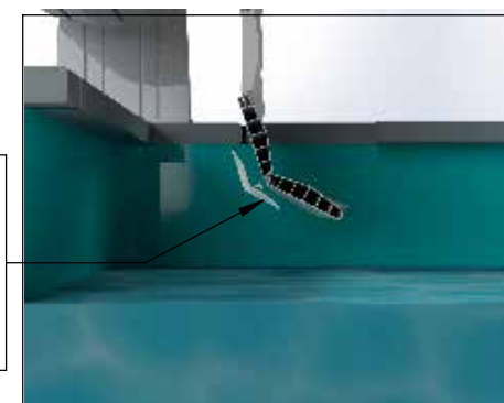
Ski de guidage lames: Faire glisser le ski PVC pour un clipsage dans la partie femelle donnant l'inclinaison de la première lames à \approx 45^\circ
